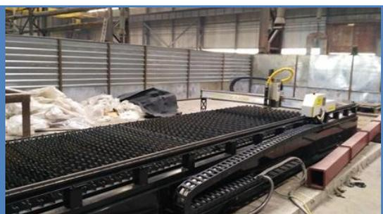
Рабочий стол обшит со всех сторон. Имеются специальные люки. В зависимости от комплектации станка подготовка к вентиляции либо отсутствует (бюджетный вариант) или выполнена система вытяжки в зоне реза, что многократно повышает производительность вытяжки.
