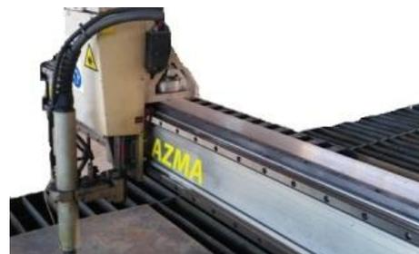
Установлены мощные двигатели с планетарными редукторами и **механизмом компенсации люфтов** в зубчато-реечной передаче. Все это повышает точность и динамичность работы оборудования и уменьшает время на обслуживание приводов.
