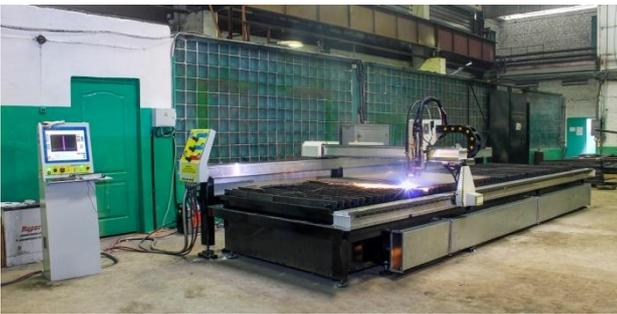
Предназначена для качественного плазменного раскроя листового металла с рабочей зоной 6100 мм x 2050 мм, толщиной до 0.5 до 100 мм (зависит от источника резки).
